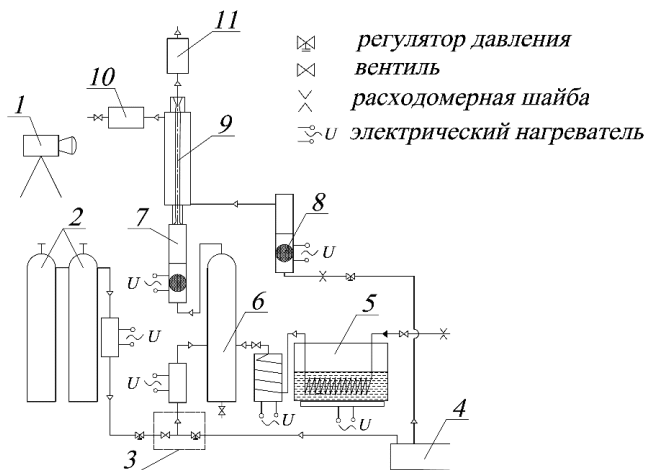
Рис. Схема экспериментального стенда с прототипом устройства температурного разделения.
