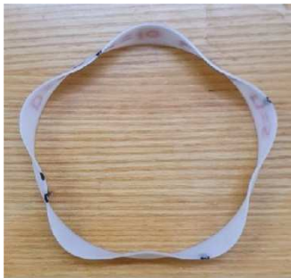
Слева направо: дефлектор с синусоидальным искривлением выходного сечения n=5 ; визуализация поперечного сечения возмущенной струи; структура возмущения в поперечной к оси струи плоскости, полученная PIV методом.
