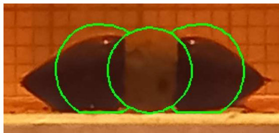
Рис. Наблюдаемая в эксперименте и численно рассчитанная (зеленая линия) форма поверхности капли МЖ объемом 0,08 мл (на водной основе, плотностью 1,2 г/см 3 , магнитной проницаемостью 1,42), окруженной трансформаторным маслом (плотностью 0,93 г/см 3 ), около шара из намагничивающегося эластомера (радиусом 0,215 см, массой 0,15 г, магнитной проницаемостью 3,62) в однородном горизонтальном магнитном поле H = 450 Э.
