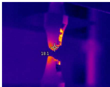
Рис. Теплограмма образца из стали Ст3сп5 в момент разрушения.
