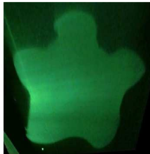
Слева направо: дефлектор с синусоидальным искривлением выходного сечения n=5 ; визуализация поперечного сечения возмущенной струи; структура возмущения в поперечной к оси струи плоскости, полученная PIV методом.
