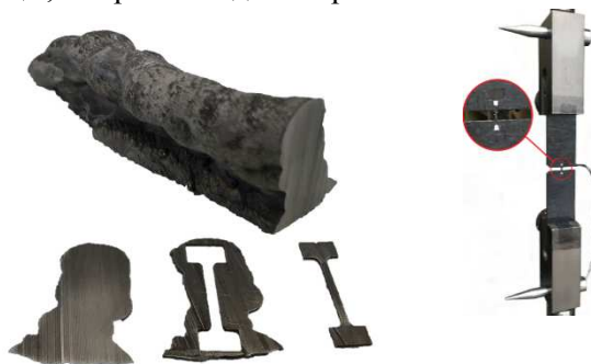
Рис. 1. Образец на растяжение, вырезанный из 5-ти слойной стенки, полученный методом послойной электродуговой наплавки и способ его закрепления в стандартных захватах испытательной машины.
